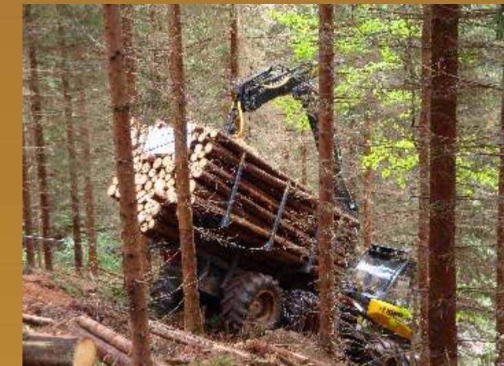
Winde am Heck des Forwarders montiert. Die vollprofessionelle Lösung für den dauernden Forwardereinsatz am Steilhang. Die Winde wird fest mit dem Hinterrahmen verbunden.
