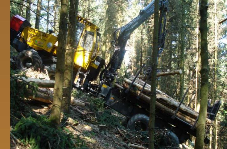
Winde am Forwarder vorne angebaut, Ladegitter hinten. Die Lösung für nicht dauernden Hang-einsatz. Auch mit Forwardern ohne Krantilt ist so leistungsfähiges Arbeiten am Steilhang möglich.
