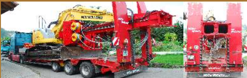
Baggerseilkran Grizzly 400 in Transportstellung auf dem Tieflader
