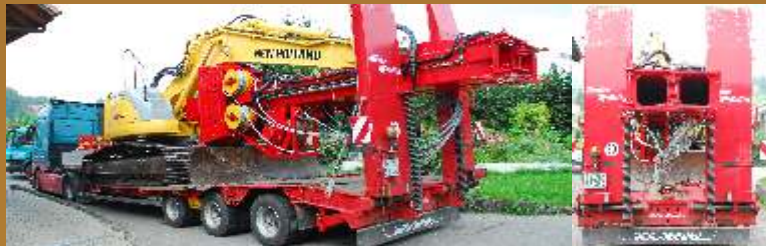
Baggerseilkran Grizzly 400 in Transportstellung auf dem Tieflader
