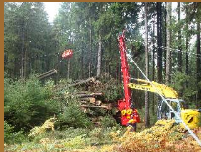
Bild oben: Maschine im 3-Seil Einsatz auf der Ebene Bild unten: Yarder-Ausführung mit Rückholseilwinde
