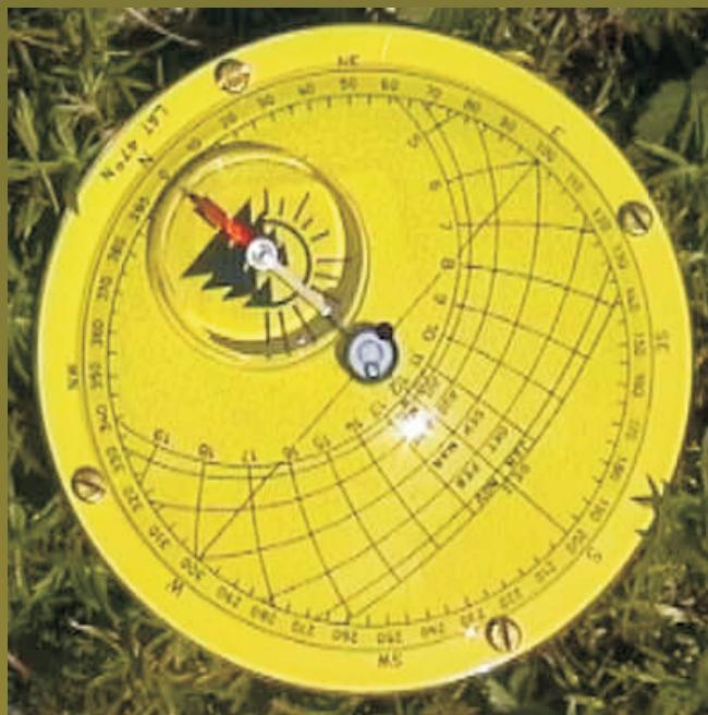
Das Gerät wird am zu messenden Platz aufgestellt und in der Kuppel spiegelt sich die Sonneneinstrahlung (auch bei bedecktem Wetter) über der Skala, auf der man dann die Anzahl Stunden ablesen kann.
