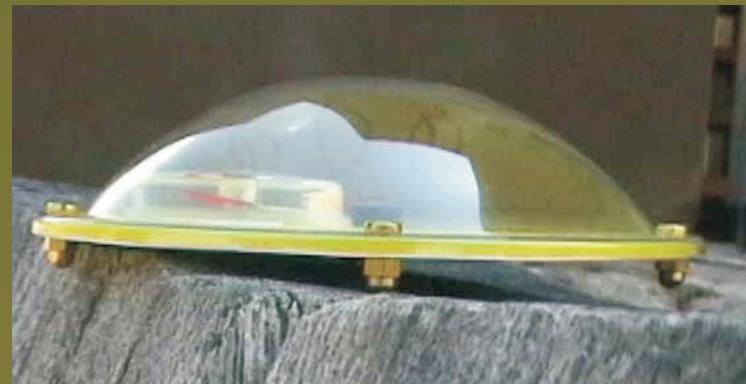
Der Sonnenkompass besteht aus einer gelb eloxierten Aluminiumscheibe von 116 mm Durchmesser mit einer schwarz aufgedruckten Skala. In der Mitte befindet sich eine Wasserwaage und darunter ein kleiner Präzisionskompass, die es erlauben, das Instrument genau nach Norden und im Lot auszurichten. Bedeckt ist das ganze mit einer Plexiglaskuppel von etwa 25 mm Höhe. Der Sonnenkompass wiegt nur 98 Gramm.
