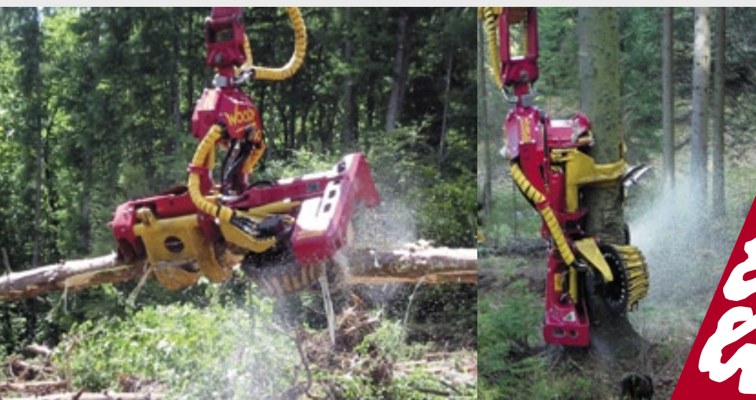
Der WOODY verfügt über eine hohe Bauhöhe, die ein kontrolliertes Fällen starker Bäume ermöglicht.
